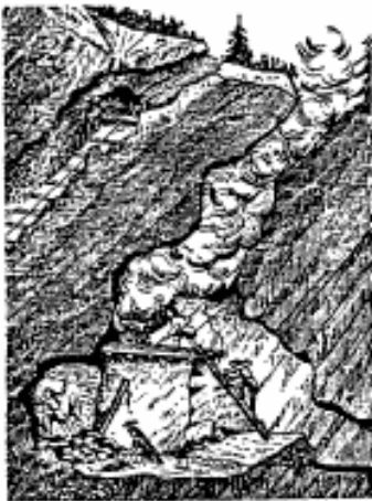
FIGURA 375—Ricostruzione di una miniera di rame a Mitterberg nel Tirolo. Il fuoco viene usato per spaccare la superficie della roccia. 1600-500 a.C.
