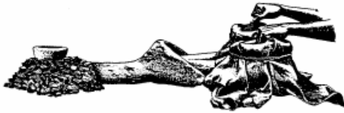
FIGURA 382—Mantice primitivo senza valvole, attualmente usato per la fusione del ferro nel Sudan. La posizione degli ugelli nella rosatura della tuyère consente l'immissione di aria fresca in quel punto e il tiraggio sul carbone acceso. Il minerale viene collocato nel crogiuolo.
