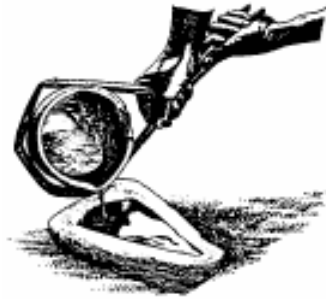
FIGURA 386—Colata di una tetta di scorie di rame in una forma aperta. Il crogiuolo viene tenuto con un manico ripiegato.
