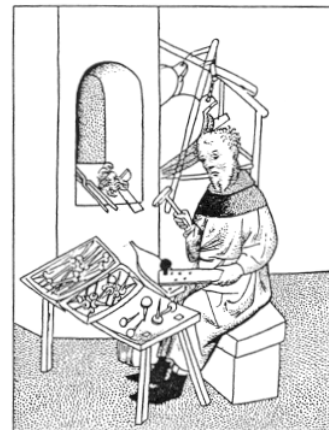
Fig.40 Chiodaio tedesco alla fine del 15° secolo. Forzando con un martello il metallo attraverso una serie graduata di fori, si otteneva un rudimentale tipo di chiodo.
