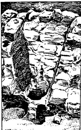
Fig. 37 Un altoforno medioevale della Jugoslavia. Nella parte anteriore sono chiaramente visibili i due condotti per l'aria. Le pareti del forno sono incrostate di quarzo corroso dalla scoria e danno un'idea delle temperature elevate che si ottenevano. Scala 1:50.
