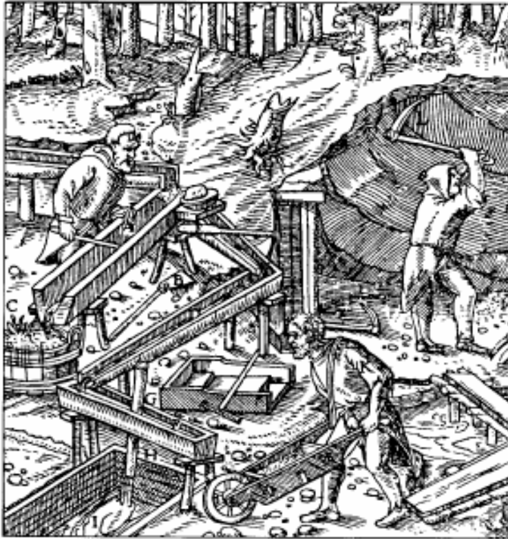
Fig. 1 Scavo di un deposito alluvionale e separazione mediante lavaggio della cassiterite (da Agricola 1556).
